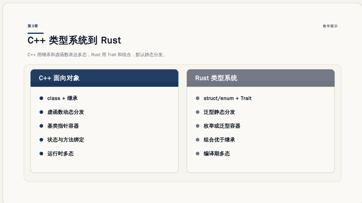
图 3.1：C++ 用继承和虚函数表达多态；Rust 用 Trait 和组合，默认静态分发。AI 直接迁移时容易保留动态分发思维。
